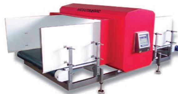
Metalldetektion in Faserballen vor einem Krepelwolf Metal detection for fiber batches before the carding willow
